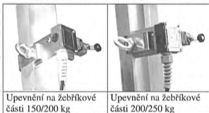
Obr. 32 Montáž horního koncového spínače
